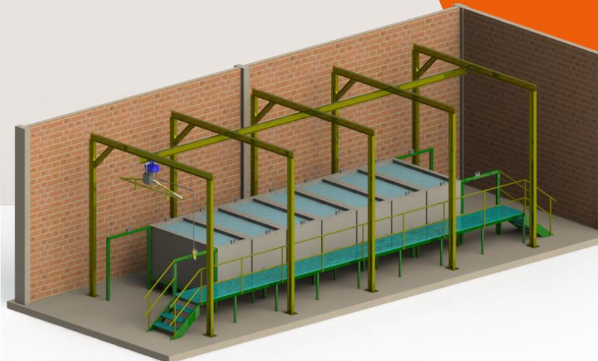
O sistema de banhos em tanques é utilizado para melhorar a aderência das peças, o que evita a corrosão. O processo é feito com controle de tempo, temperatura, concentração dos produtos químicos e cuidado para evitar a contaminação dos banhos.
