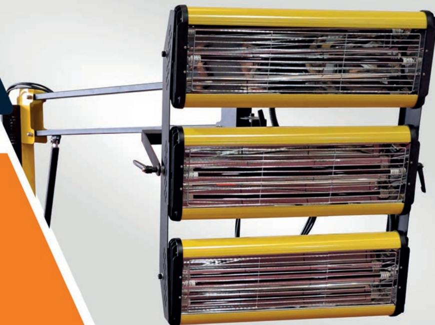
O **Painel de Secagem Rápida IR3000** da Orange foi projetado para agilizar o processo de secagem dos componentes de pintura automotiva ou industrial. Foco principal na redução de tempo pela utilização de lâmpadas infravermelhas, que produzem grande quantidade de calor e ondas IR de grande eficiência, assim o processo de cura ocorre de dentro para fora.
